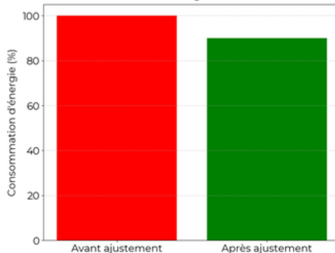
Réduction de la consommation d'énergie avec la climatisation à 26°C en été
